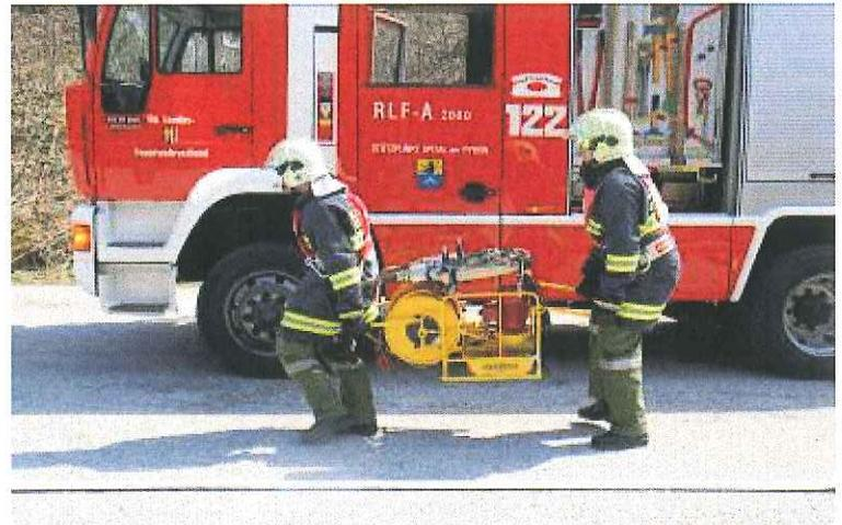
Entnahme des hydraulischen Rettungsgerätes
